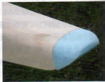
↓先端はスタイロフォームのブロックを整形して作る。
