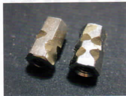
↑水平尾翼を留める長ナットは、ヤスリでこのように溝を付けてから接着するとよい。
