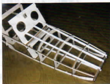
→機首上部のカーブには、バルサ棒を入れて凹まないようにする。
